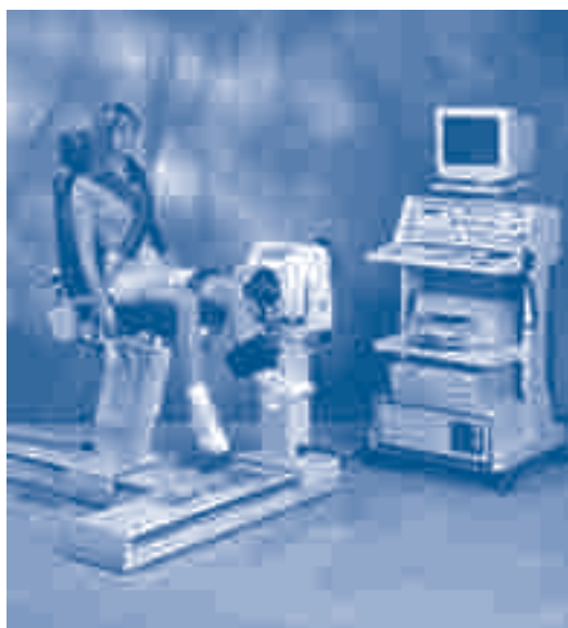
Aparato para la medición de contracciones isocinéticas
